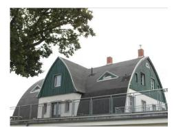
Optisch sind die Dachflächen gebogen, der First benötigt keine separate Unterstützung und der Dachraum kann frei gestaltet werden.
